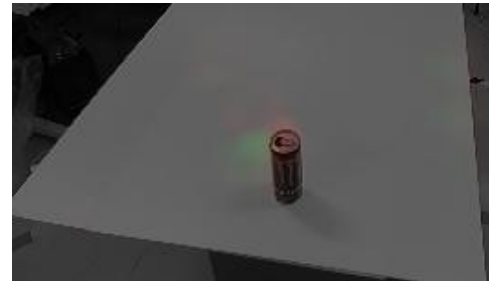
Fig.11 入力画像と想起結果を重ね合わせた様子; 赤色:物体領域マスク、緑色:手領域マスク
