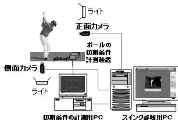
図 1: スイング診断システムのハード構成
