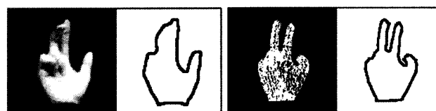
図 15 照合結果 (3.5 の照合方法) Fig. 15 Matching result. (method described in 3.5)
